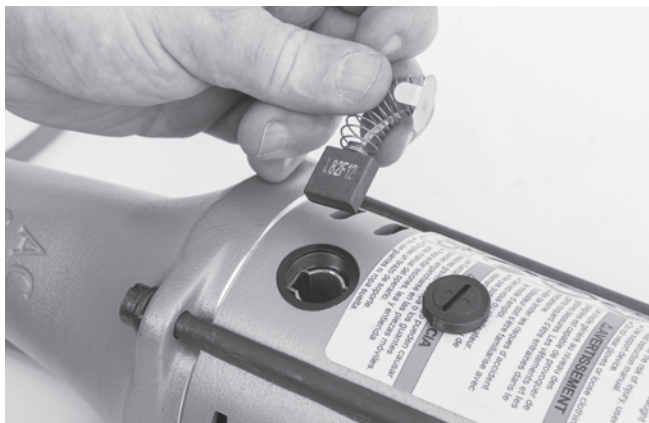
Figura 13 – Colocación de la escobilla
