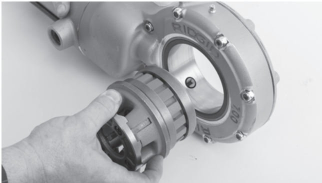
Figura 4 – Montaje del cabezal roscador en el accionamiento motorizado 700
